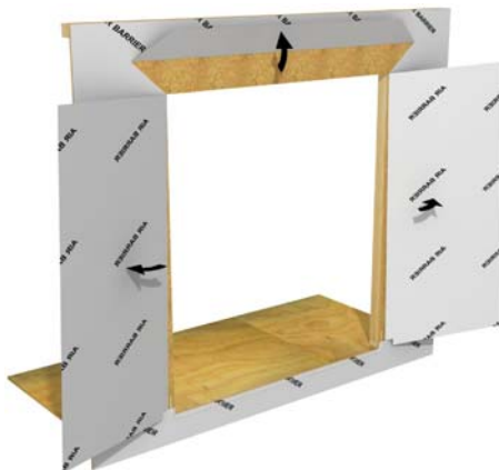
Figura 9: Arrolle la barrera resistente al clima (WRB) y aplique sellador
