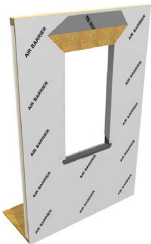
Figura 7: Coloque sellador sobre los sujetadores
