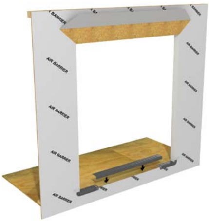
Figura 12: Instale la pieza central y aplique adhesivo
