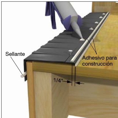
Figura 19: (Puertas) Selle los sujetadores y aplique adhesivo de construcción
